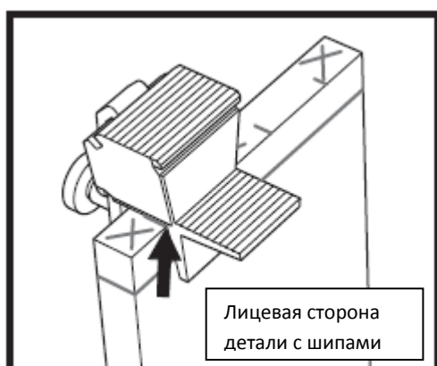
Рисунок 10: стусло установлено. Участок, отмеченный крестиком должно быть открыт, а левый край стусла располагается точно на разметочной риске!
