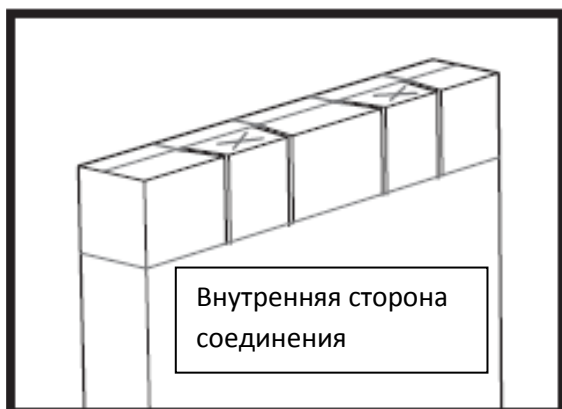
Рисунок 26. Вид детали с зубцами после выполнения пропилов.
