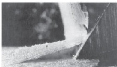
Фото 1: тип стружкообразования производит очень гладкую поверхность при резке параллельно с зерном.
