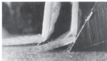
Фото 1: тип стружкообразования производит очень гладкую поверхность при резке параллельно с зерном.
